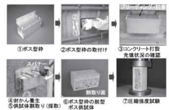
図1:ボス供試体による圧縮強度試験
