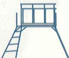
（※）足元の高さが2m以上の箇所で作業する場合には、原則として十分な広さと強度をもった作業床や墜落防止措置（手すり等）を備えた用具を使用してください。特に、はしごは原則昇降のみに使用してください。
